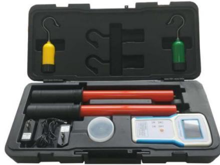
HBR-900 高压无线核相器用于两条高压线路并网或环网核相。该仪器可以升级远程核相的功能。仪器适合 0.22kV~500kV 交流输电线路带电作业和二次侧带电作业，具有高压验电功能。
